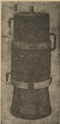
Фиг. 9. Ртутный выпрямитель системы А.Е.Г. на 30 kW трехфазного тока.
